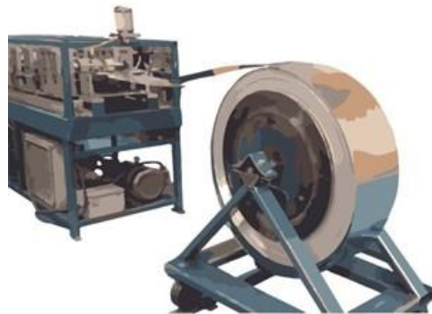
Figura 3. Proceso de rolado (formado en frío)
