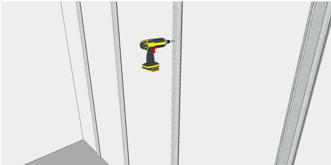
Figura92. Fijación de la estructura
